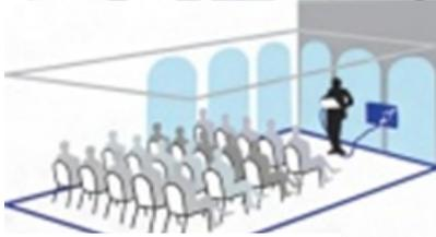
Индукционная система с усилителем предназначена для использования в помещениях площадью от 30 до 700 м<sup>2</sup>, размещается на полу либо потолок помещения и коммутируется с аудиосистемой в непосредственной близости от индукционной катушки.
