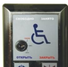
открывания дверей: нажатием кнопки; движением руки перед датчиком; при помощи пульта; автоматическое открывание (при наличии датчика).
